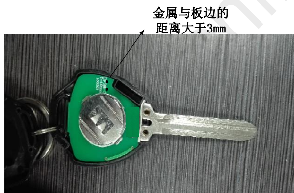
图 6. 保持内部电路与结构边缘的距离
