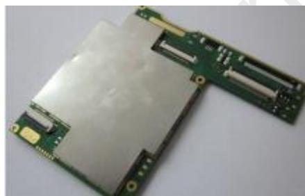
图 8.用屏蔽罩保护电子线路
