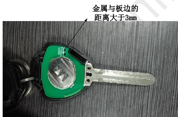
图 6. 保持内部电路与结构边缘的距离
