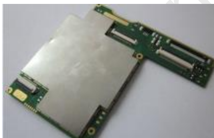
图 8.用屏蔽罩保护电子线路
