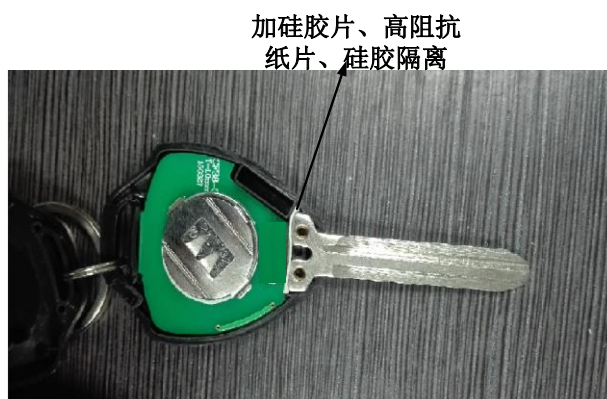
图 5. 隔离金属插入件的静电途径
