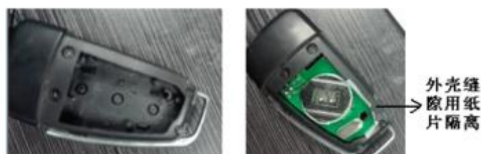
图 4. 保持缝隙的密封程度
